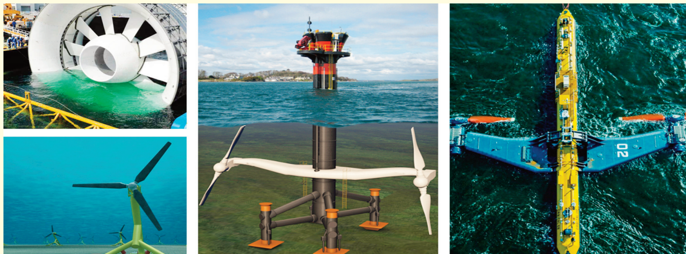
Figura 1. Tipos de dispositivos para captación de energía marina: turbina de eje horizontal con conducto (arriba izquierda) [Quintero González & Quintero González, 2016], turbina de eje horizontal fija al lecho marino (abajo izquierda y centro) [Hardisty, 2009], turbina de eje vertical [Royal Haskoning, 2011].
